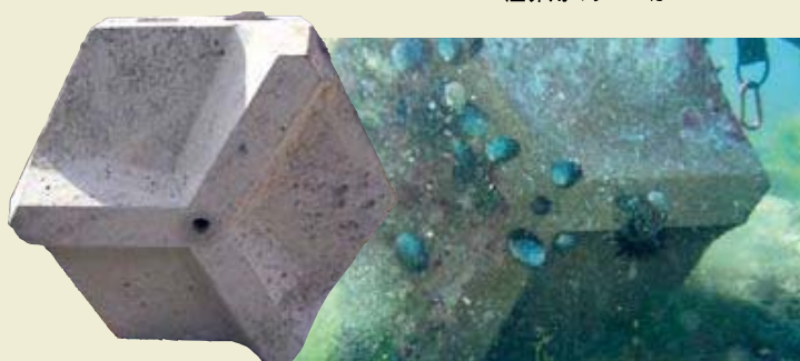
焼酎粕コンクリートでつくったトコブシ魚礁狭いところを好むトコブシの習性を利用し、魚礁に凹凸をつけ、常に海底と魚礁との間にすきまができるよう工夫している
